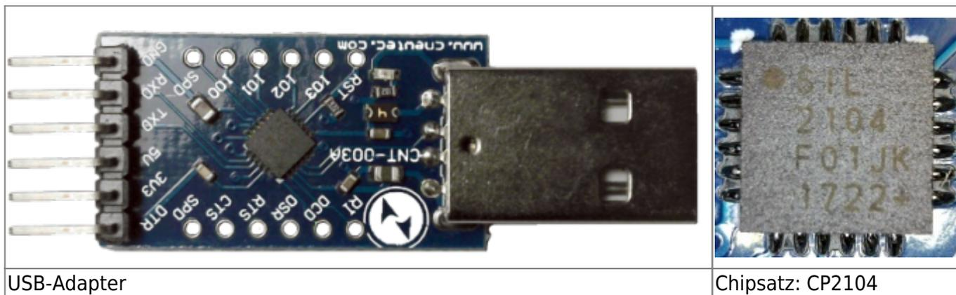
Diesen USB-Serial-Adapter verwende ich hauptsächlich mit Windows 10 zum Flashen von Tasmota. Einfach problemlos. Auch im Dauereinsatz mit einem seriellen GPS-Empfänger. □
