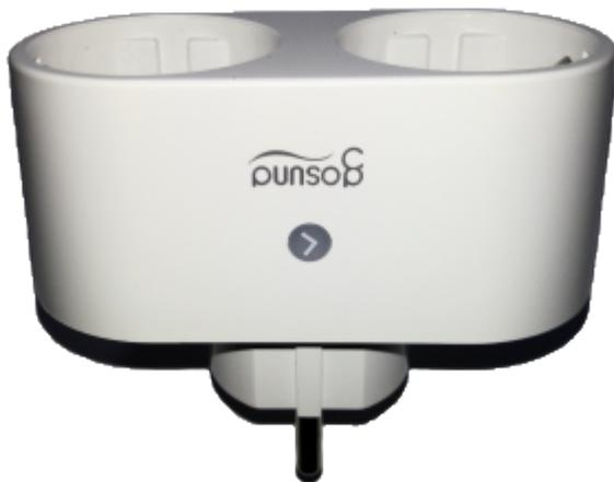
Mit dieser „smarten“ Doppelsteckdose kann man mit Hilfe der App „[Gosund](#)“ (Android) über das WLAN und einer Cloud Kontakt zu diesen Gerät aufnehmen. Dabei landen die Daten auf der IoT Plattform von Tuya. ([Hauptsitz - GoogleMaps](#))
