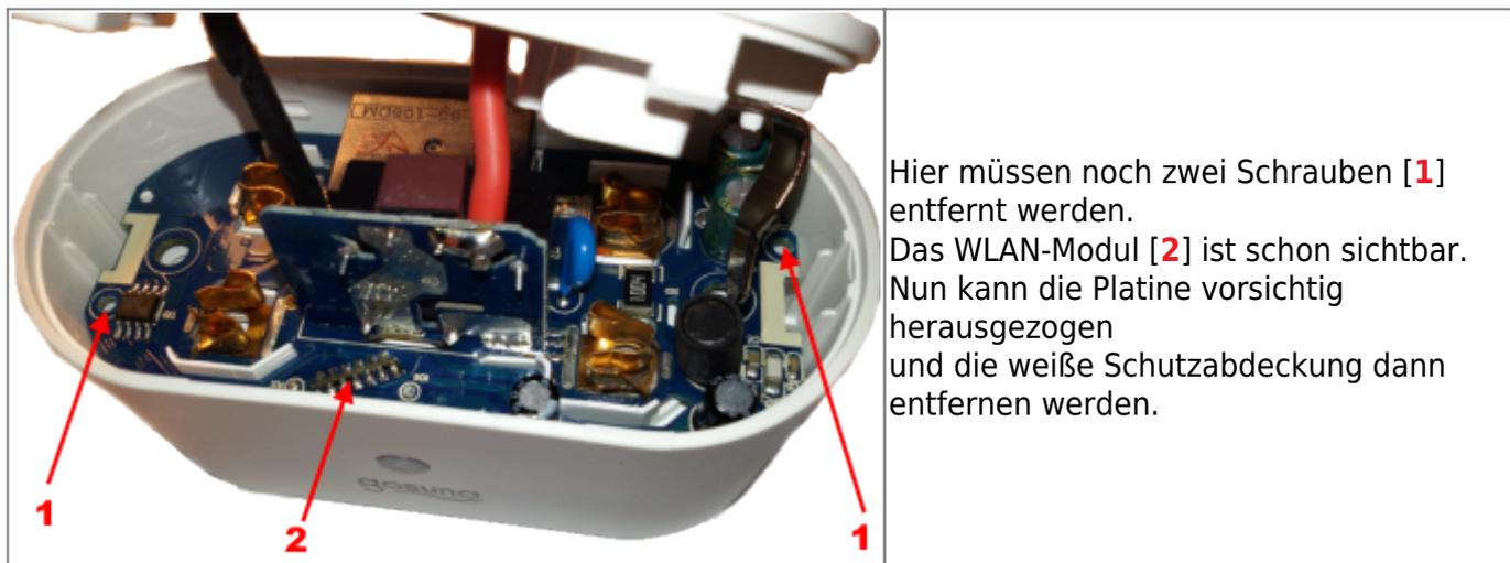
Hier müssen noch zwei Schrauben **[1]** entfernt werden. Das WLAN-Modul **[2]** ist schon sichtbar. Nun kann die Platine vorsichtig herausgezogen und die weiße Schutzabdeckung dann entfernen werden.
