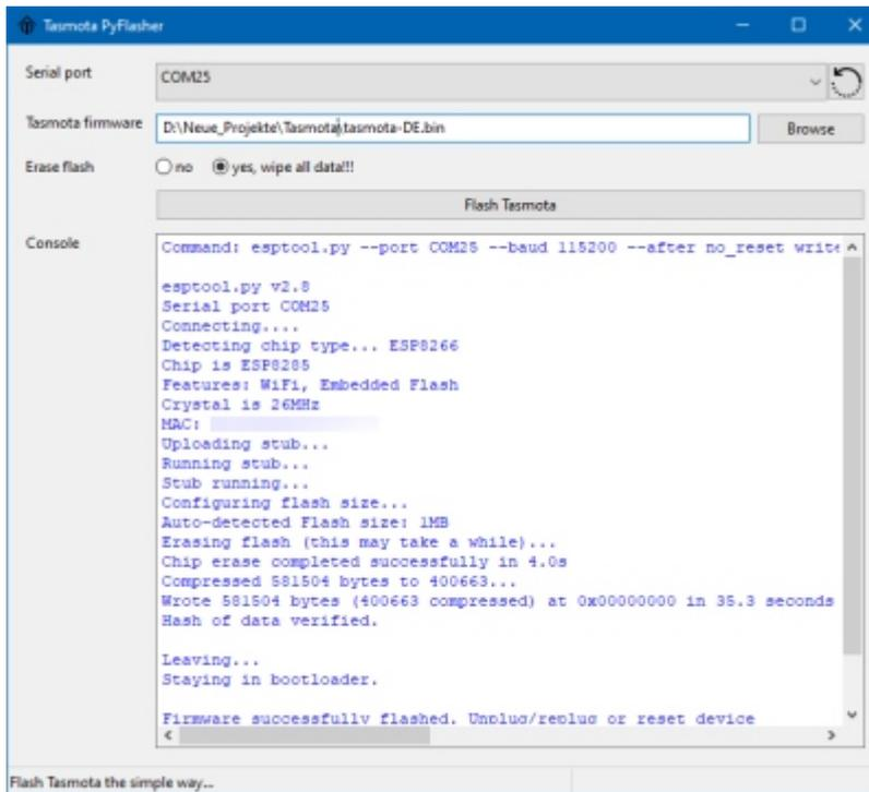
Mit Hilfe des Programms „[Tasmota PyFlasher](#)“ wird die neuer Firmware in Form der Datei `tasmota-DE.bin` (Tasmota) auf das TYWE2S-Modul übertragen. Hierbei muss „yes, wipe all data!!!“ ausgewählt sein.
