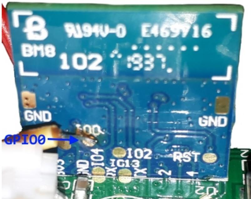
GPIO0 auf der Rückseite wird mit der Masse GND verbunden. Alle anderen Anschlüsse werden mit einem UART/USB-Konverter verbunden wobei RXD auf TXD am Konverter und TXD auf RDX auf den Konverter verbunden wird. Die Stromversorgung der Steckdosenleiste (230V) darf dabei nicht verwendet werden - der Konverter stellt die benötigten 3,3V selbst her.
